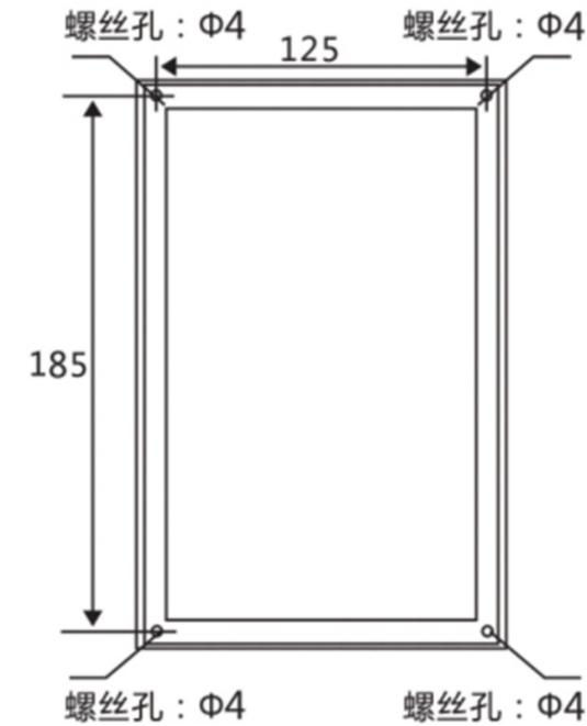
安装螺丝孔距：125mmx185mm
